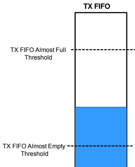
**Figure 11. FIFO Threshold**
