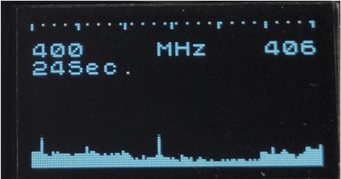
Il est composé de la Bande ici 400 à 406Mhz, Du temps d'affichage restant ici 24s, par défaut d'un marquage de 1Mhz et des barres représentant le spéctre.
