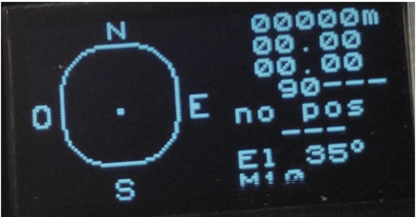
Un cadran cardinal nord, ouest, est sud qui représente la direction de la sonde , 00000m l'altitude, 00,00 la vitesse en km/h, 00,00 la montée ou descente m/s, 90 course°, — bearing°, no pos la distance, E1 35° l'élévation, et M10 le type.
