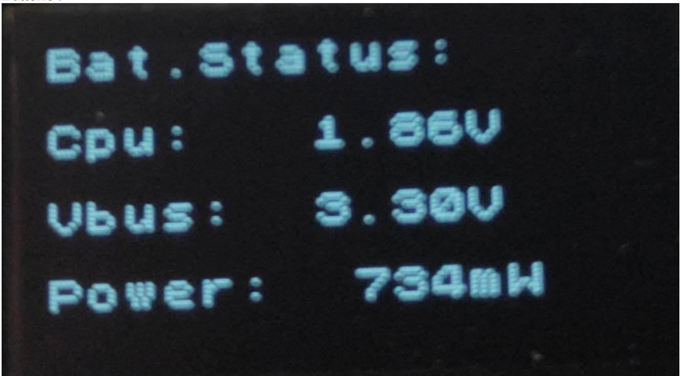
Cpu la tension relative à la batterie ( de 1,74 à 1,94) à mettre dans config pour étalonner votre système
