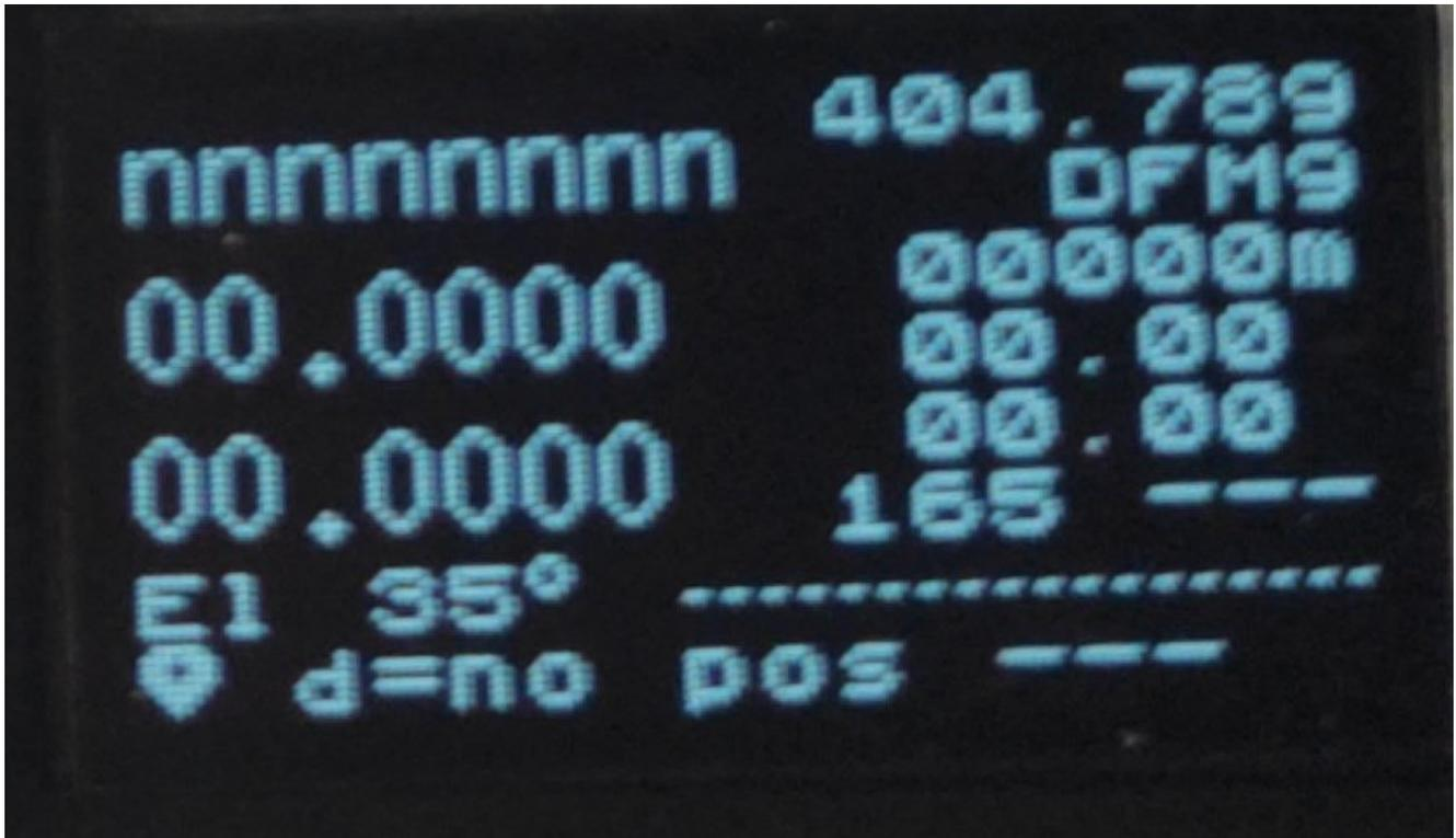
nnnnnnnn le numéro de série de la sonde, 00,000 la lat et lon, E1 : 35° élévation,, symbole GPS, d= distance actuelement no pos, — la direction °, la fréquence, le type, 00000m l'altitude, 00,00 la vitesse km/h, 00,00 la monté ou descente m/s, 165 course ,---brearing, ----signal reçue – rien, | reception E erreur
