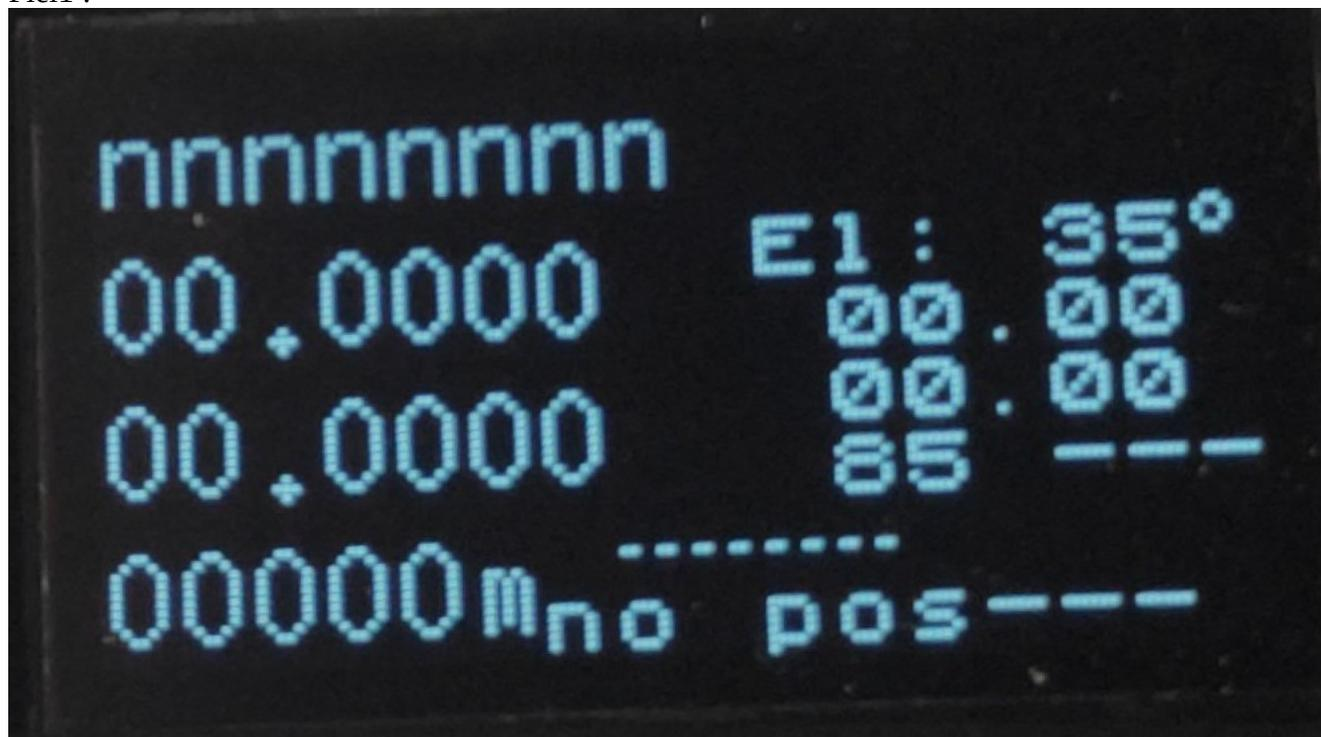
nnnnnnnn le numéro de série de la sonde, 00,000 la lat et lon, 00000m l'altitude, E1 : 35° élévation, 00,00 la vitesse km/h, 00,00 la montée ou descente m/s, 65 course, ---bearing, ----signal reçue – rien, | reception E erreur, no pos la distance, la direction ---°
