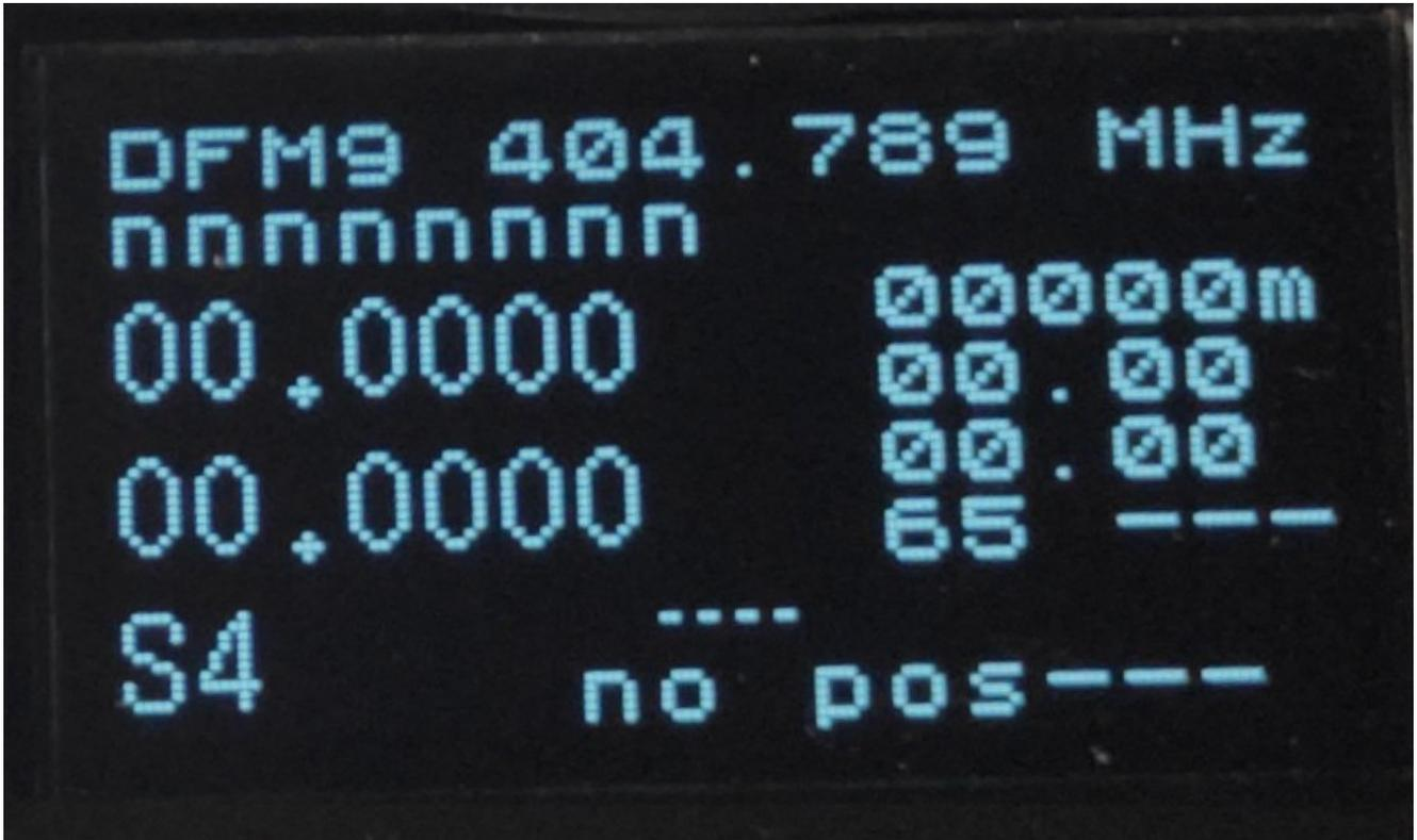
DFM09 le type, 404,789Mhz la fréquence, nnnnnnnn le numéro de série de la sonde, 00,000 la lat et lon, S4 le signal reçue en smètre ou dB, 00000m l'altitude, 00,00 la vitesse km/h, 00,00 la monté ou descente m/s, 65 course ,---brearing, ---signal reçue – rien, | reception E erreur, no pos la distance, la direction ---°
