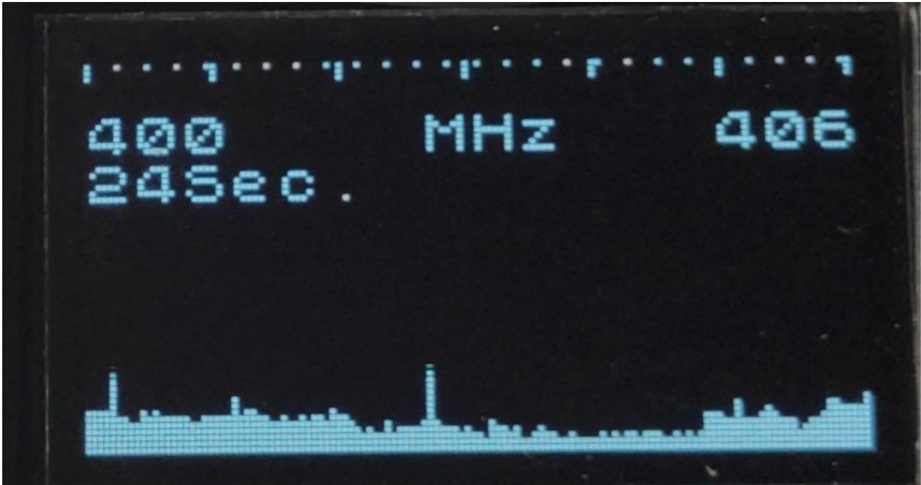
Il est composé de la Bande ici 400 à 406Mhz, Du temps d'affichage restant ici 24s, par défaut d'un marquage de 1Mhz et des barres représentant le spectre.
