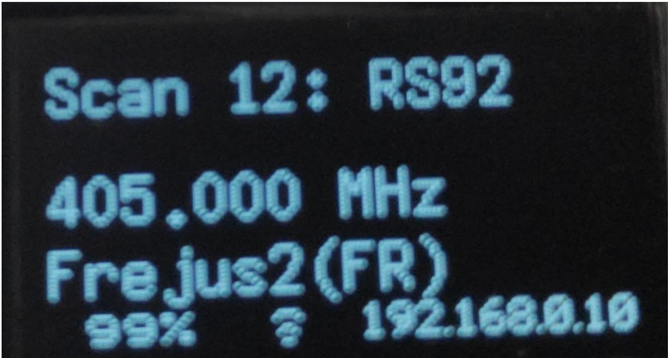
12 représente la position dans QRG, RS92 le type de la sonde, et 405,000Mhz la fréquence puis le nom donné à cette sonde, 99 % le pourcentage de la batterie suivant l'étalonnage dans config ! Suivie du symbole wifi et l'adresse IP
